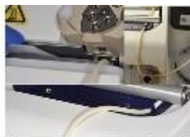
Lắp đặt Amplification Plate và ống dẫn
