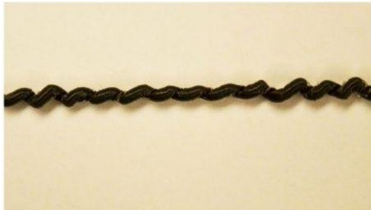
Ảnh: Phóng to sợi cơ carbon được cuộn gia cố có đường kính 0,4 mm.
