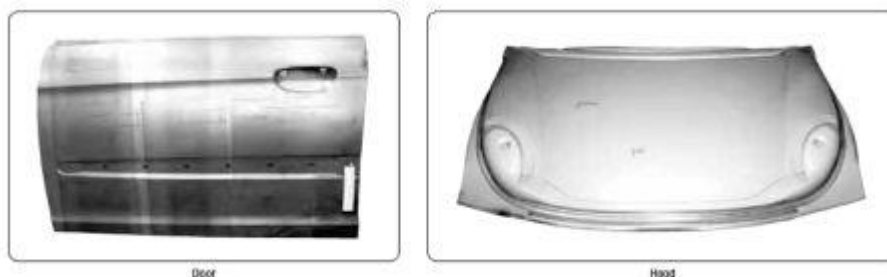
Chi tiết cửa và nóc vỏ xe ô tô chế tạo từ thép ULC sau cán nguội (Automotive Steel, POSCO, 2014)
