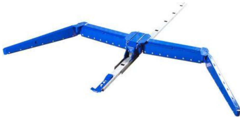
Hình 2.7: Kiểu kéo bằng thanh khớp nối
