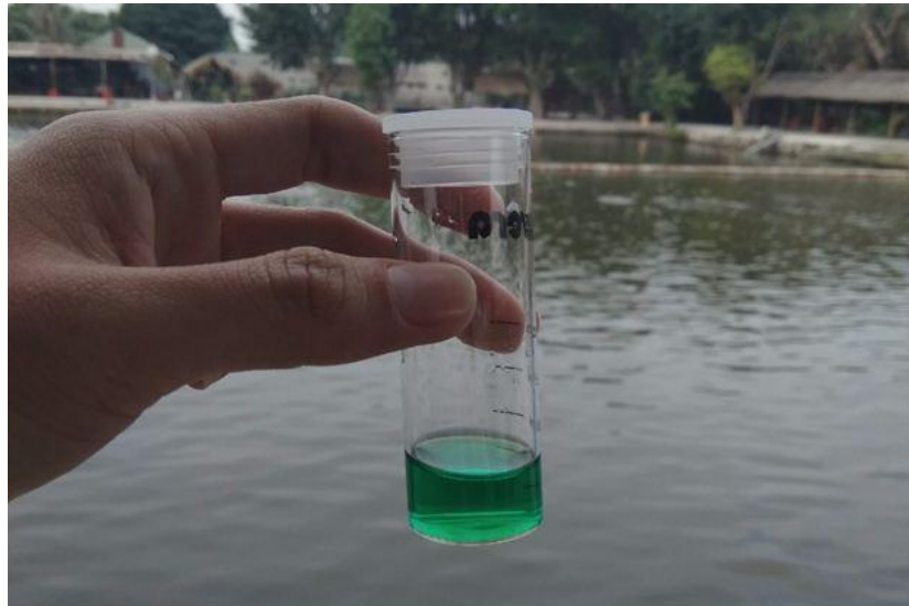
Kết quả đo được là khí độc NH 3 trong ao nhiễm ở mức 3mg/L – nhiễm rất cao
