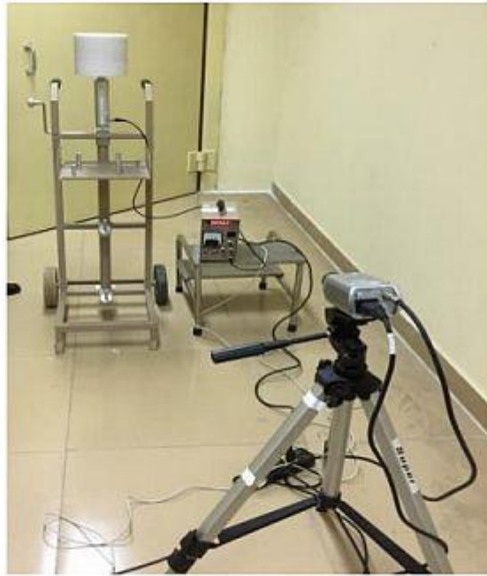
Hình 2.22: Bố trí thí nghiệm hệ đo phổ neutron sinh ra từ máy gia tốc y tế
