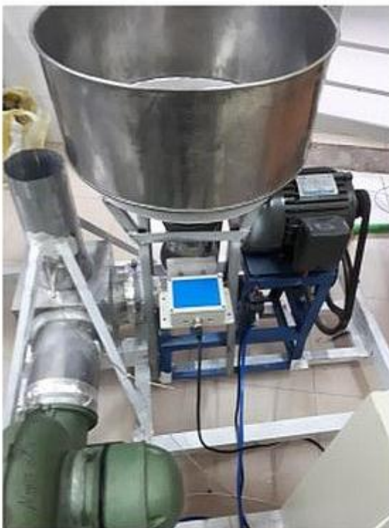
Hình 2.27. Mô phỏng tiếp liệu bột ướt có điều khiển, giá gà lắp sensor đo độ ẩm
