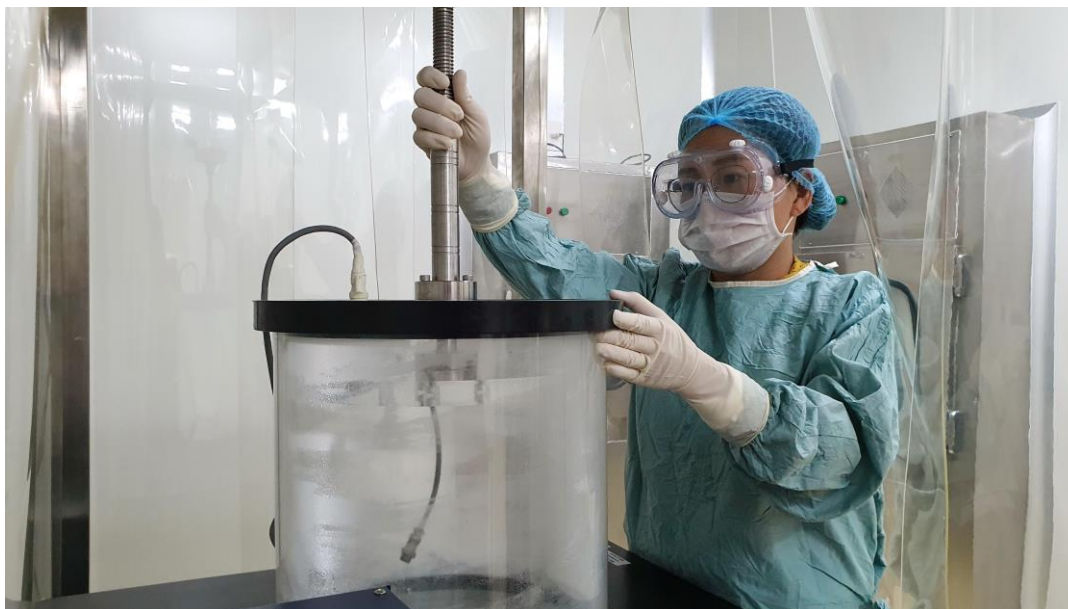
Vận hành máy đông khô trong sản xuất KIT tại Trung tâm Đồng vị, Viện Nghiên cứu hạt nhân Đà Lạt.
