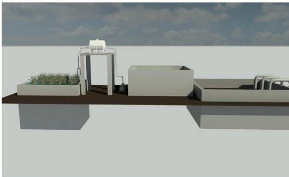
Hình 3. 1. Mô hình quy trình công nghệ xử lý nước thải công nghiệp bằng hồ sinh học phủ hệ thực vật Cỏ Lông Tây
