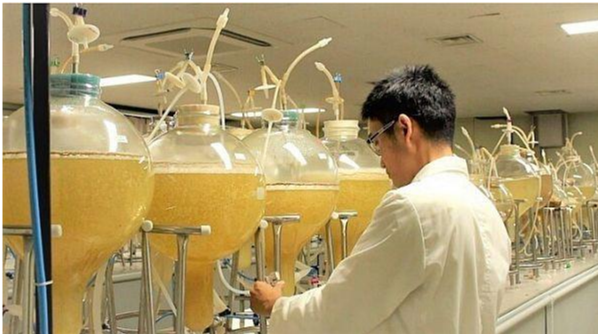
Hệ thống nuôi cấy sinh khối (mô, tế bào thực vật, cơ quan) để tạo dược chất. Ảnh: NVCC.
