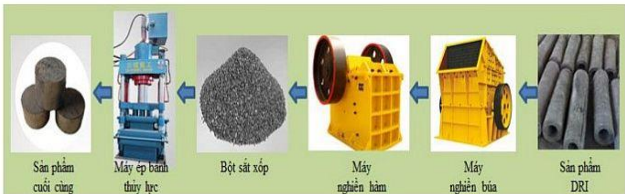
Lưu trình công nghệ ép đóng bánh sắt xốp sử dụng máy ép thủy lực
