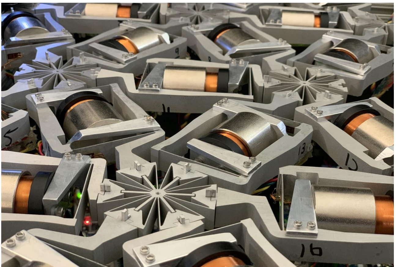
Hình ảnh của một mạng nơ-ron cơ học (MNN). Hiện tại, hệ thống này có kích thước bằng lò vi sóng, nhưng các nhà nghiên cứu có kế hoạch đơn giản hóa thiết kế MNN để hàng nghìn mạng có thể được sản xuất ở quy mô vi mô trong mạng 3D cho các ứng dụng vật liệu thực tế.
