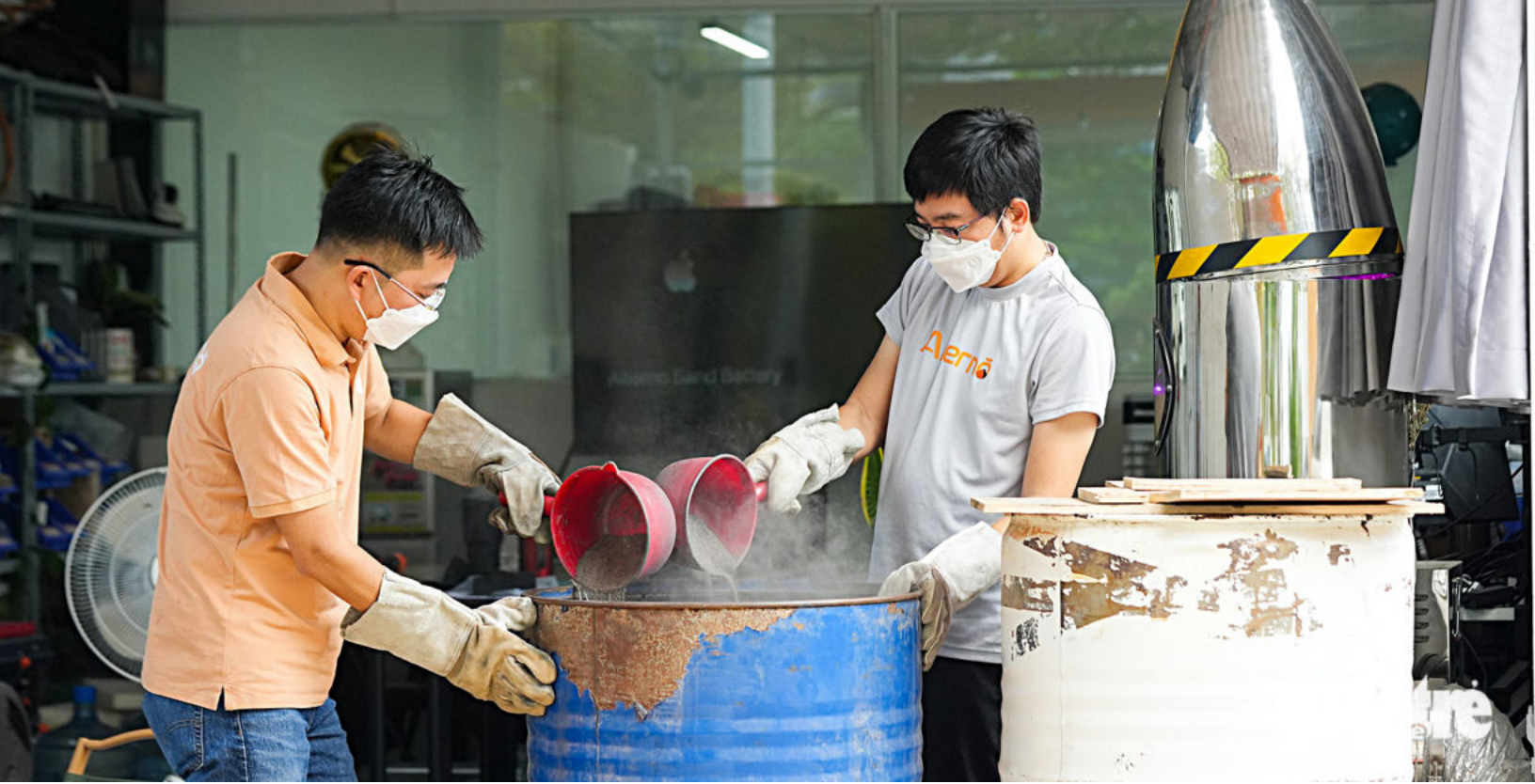
Các thành viên trẻ Công ty Alterno thí nghiệm nấu nước nóng từ hệ thống pin cát do nhóm nghiên cứu là startup tiêu biểu tham dự giải thưởng Tuổi Trẻ Startup Award 2023.
